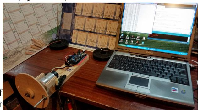
Cette fois, le terminal de l'ordinateur enregistre simultanément, 2 fois par seconde, la tension d'alimentation du moteur, le courant courant d'alimentation et la vitesse de rotation.
