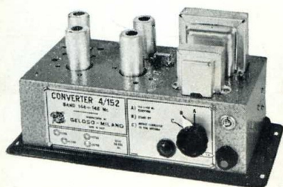
4/152 : Convertisseur pour la réception de la gamme 144-146 MHz (bande 2 mètres). Fréquence intermédiaire 26-28 MHz. Commutateur sélecteur d'antenne. Alimentation incorporée au convertisseur. Secteur alternatif de 110 à 220 volts.
