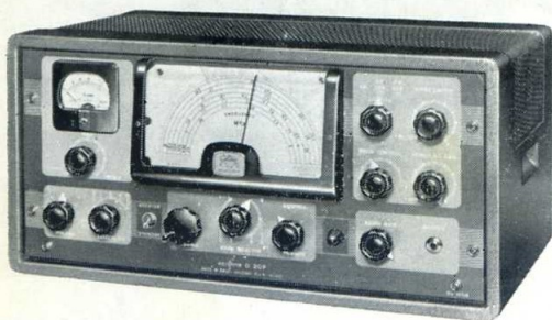
G209R : Récepteur professionnel de trafic radio. 6 gammes : 10, 11, 15, 20, 40, 80 m. Réception AM-CW-SSB. Contrôles à cristal. Limitateur de parasites. Sensibilité 1 mV. Rapport signal/bruit supérieur à 6 dB. Puissance BF 1 watt. Dimensions : 52x26x25 cm.
