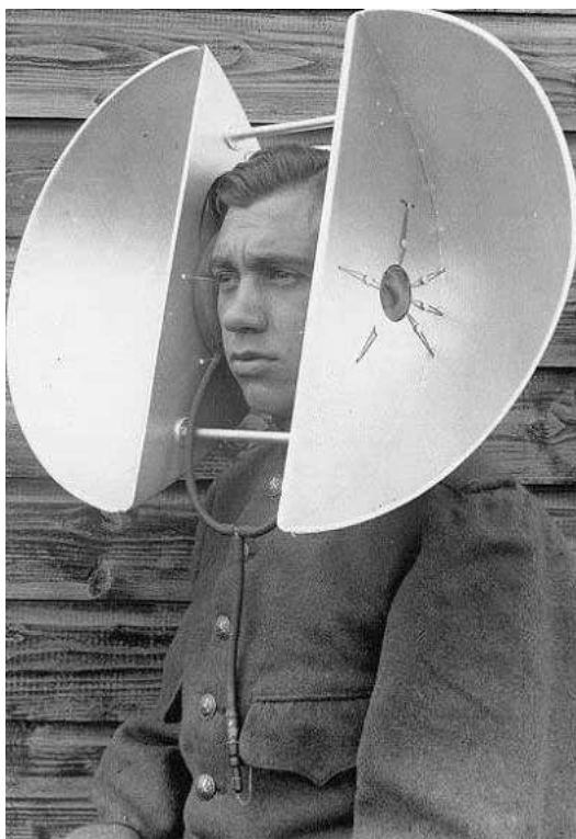
Essais de détection acoustique des avions dans les années 1930 par l'Armée Rouge.
