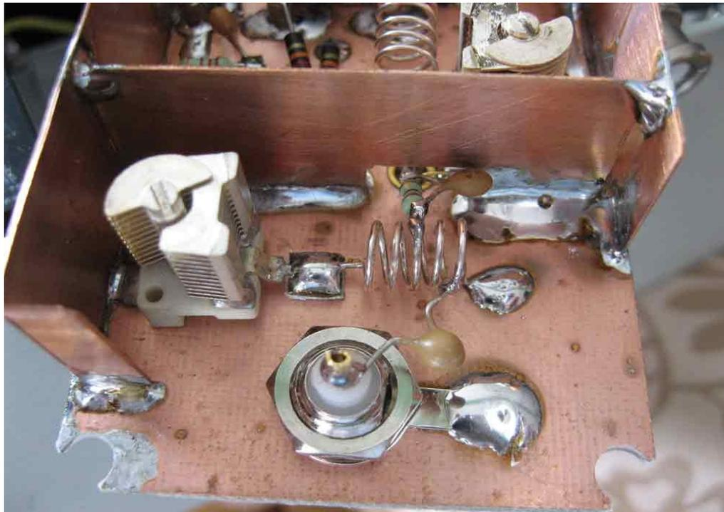
*Vue sur le circuit d'entrée du préamplificateur 144*
