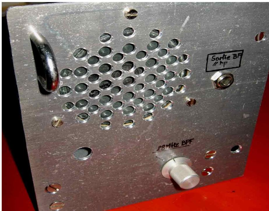
***Filtre 28MHz** La face avant comporte, outre l'accord du filtre, un petit haut-parleur et un jack « sortie BF ». Permet la connexion à un enregistreur numérique voire vers un PC portable. Des logiciels audio grand public comportent parfois, en plus de la fonction de base, une visualisation spectrale de la modulation voire une enveloppe sur un enregistrement longue durée.*
